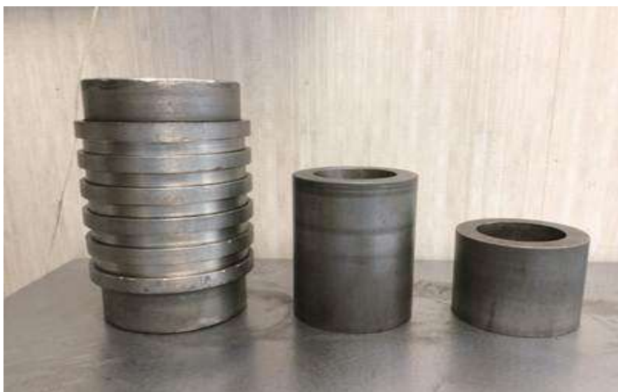
3 - сурет. Асфальт қоспасынан үлгілерді дайындауға арналған пішін
