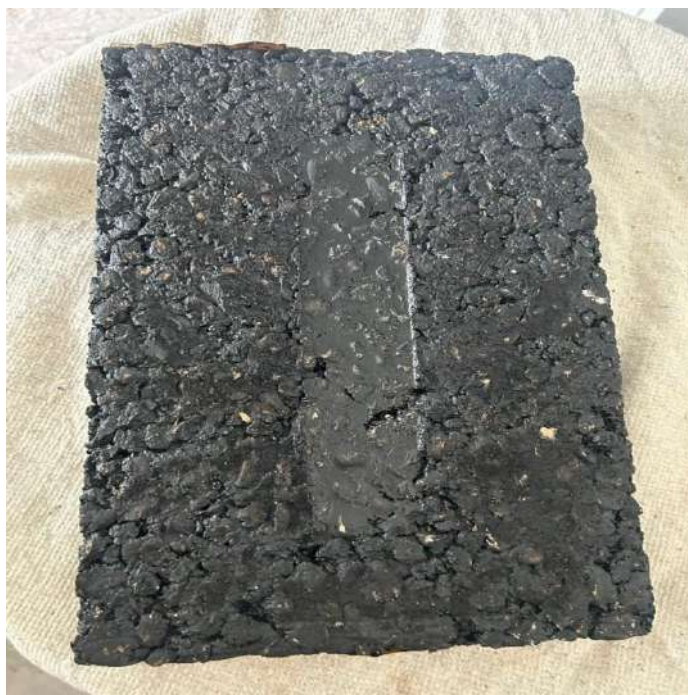
8 – сурет. Жолтабан орташа тереңдігі анықталған үлгі
