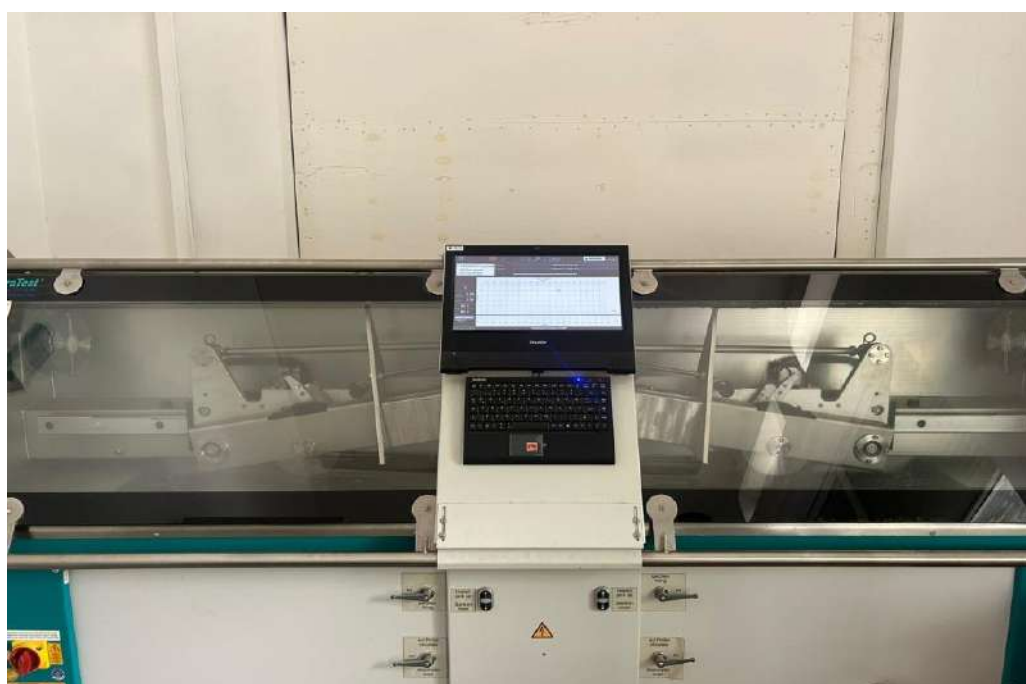
7 - сурет. Жолтабанның орташа тереңдігін сынауға арналған құрал
